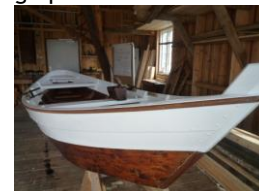
Den færdige gafpram med trætjære og linoliemaling - klar til søsætning d. 8. maj.
